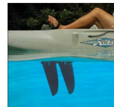
De voetaandrijving van de ook in Nederland verkrijgbare Hobie Mirage Outback.
